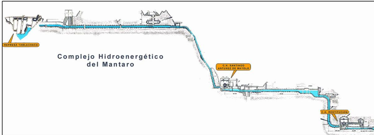
Las aguas turbinadas de esta central, son canalizadas a través de un puente tubo de 100 metros de longitud, hacia otro túnel de 800 metros, para llegar a la segunda central aprovechando una caída neta de 257 metros.
