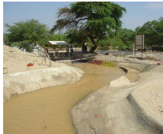
Vista panorámica del Embalse Tablachaca reproducida en el Modelo Hidráulico
