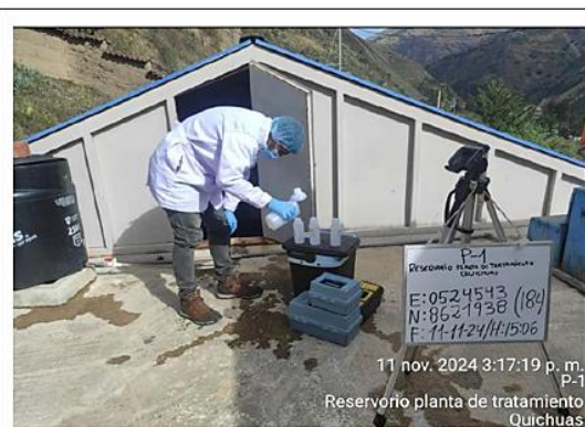
Toma de muestras de agua potable en Quichuas
