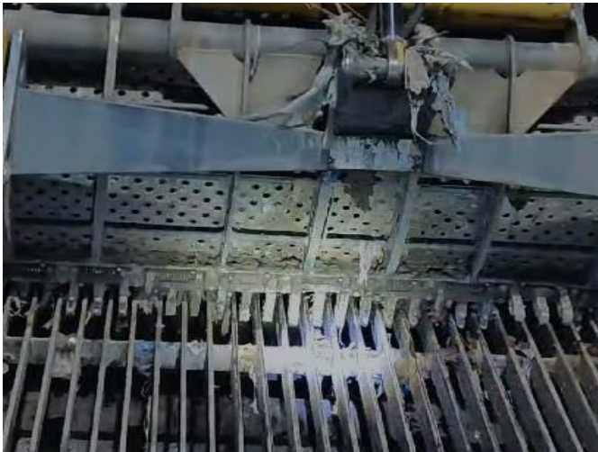
Fig. N° 07 – Diseño actual del mecanismo de limpieza de la cuchara, requiere ser modificado con el nuevo diseño de rejas.
