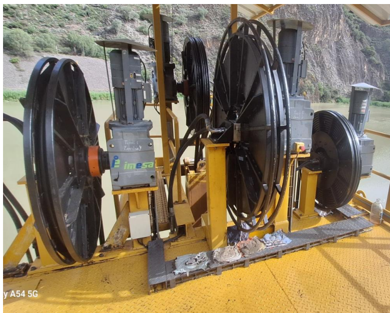
Fig. N° 08 – Daños en las mangueras a cauda del problema de sincronización de los enrolladores
