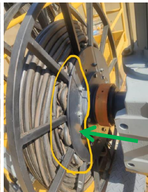
Fig. N° 08 – Daños en las mangueras a cauda del problema de sincronización de los enrolladores
