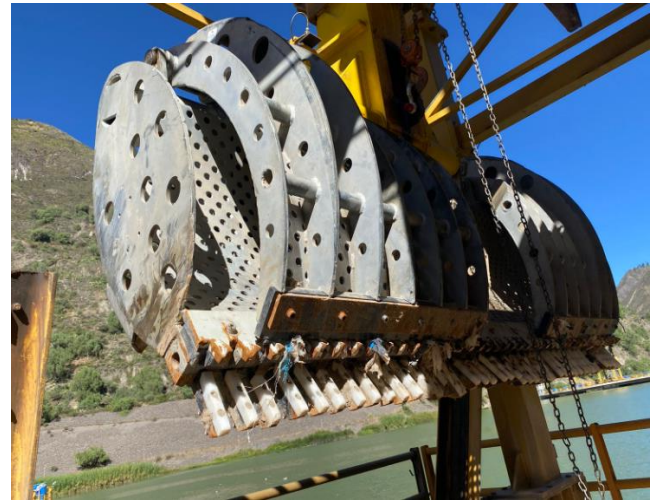
Fig. N° 07 – Diseño actual del mecanismo de limpieza de la cuchara, requiere ser modificado con el nuevo diseño de rejas.
